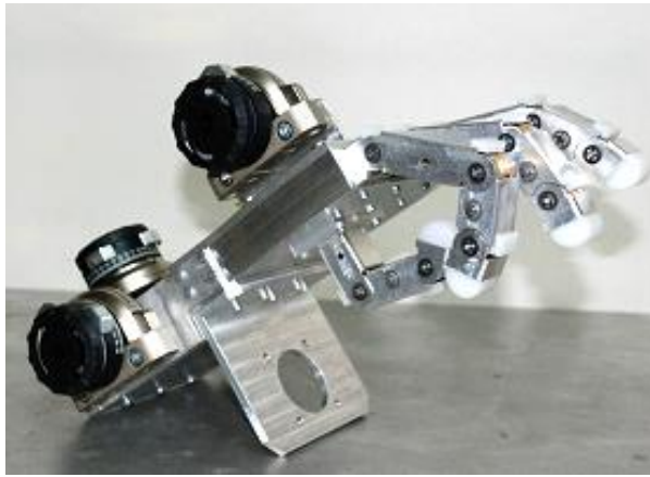
Рис.8.54. Конструкції адаптуючих багатопальцевих ЗП
