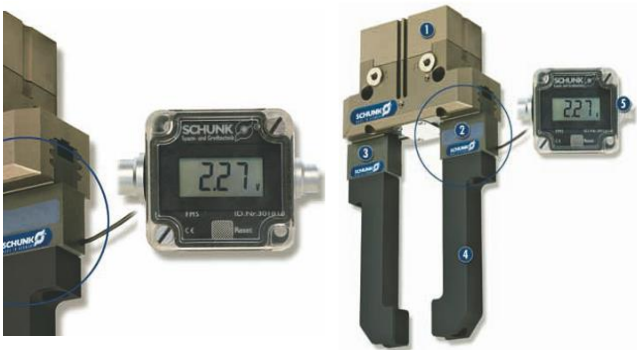
Рис.10.15. Система моніторингу сил затиску та положення затискних важелів ЗП:
