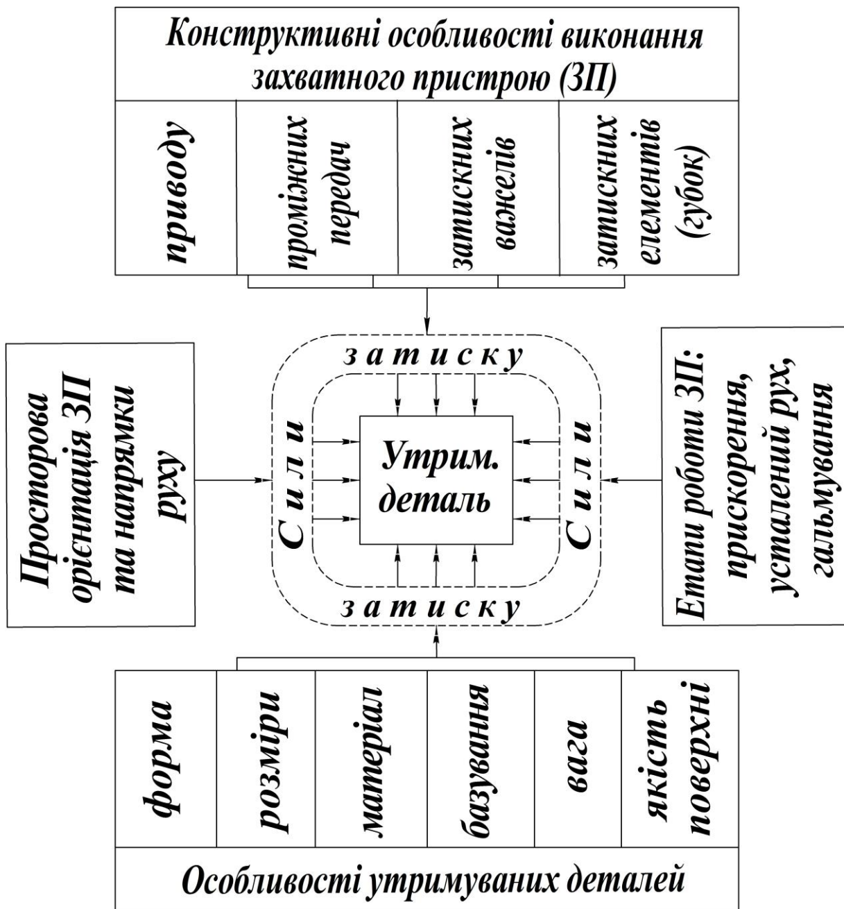
Рис.5.1. Структура силового навантаження захватного пристрою
