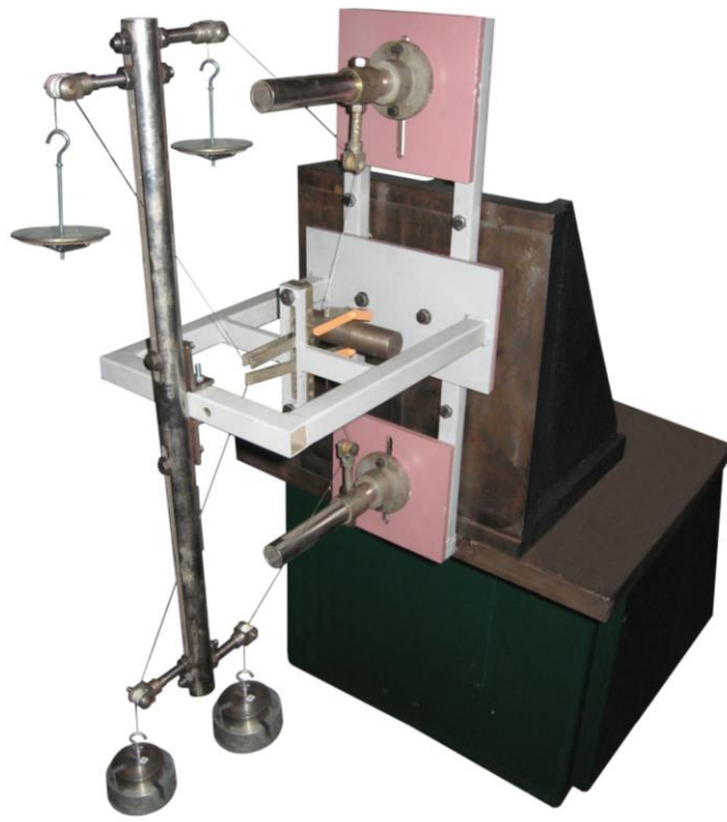
Рис.10.2. Двоточкова та чотириточкові установки для визначення мінімально необхідних сил затиску:
